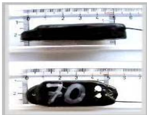
Bild 4. Radiosändare av märket ATS, www.atstrac.com , (modell F2120) som använts i denna studie. Märkets vikt är c. 15 g. Måtten på bilden är i centimeter (5,5 x 2,0 x 1,0 cm).
